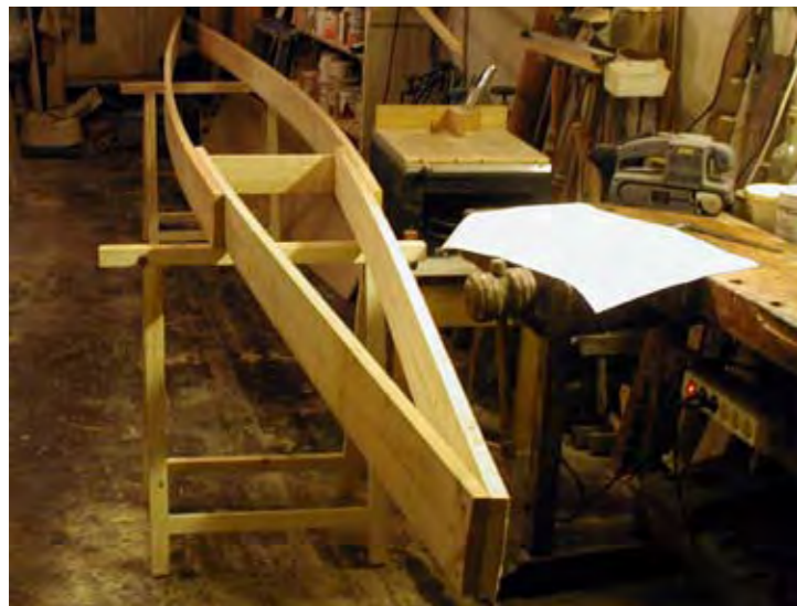
En enkel och funktionell byggjigg
