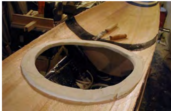
Skumform på däckets undersida för en försänkt sarg
