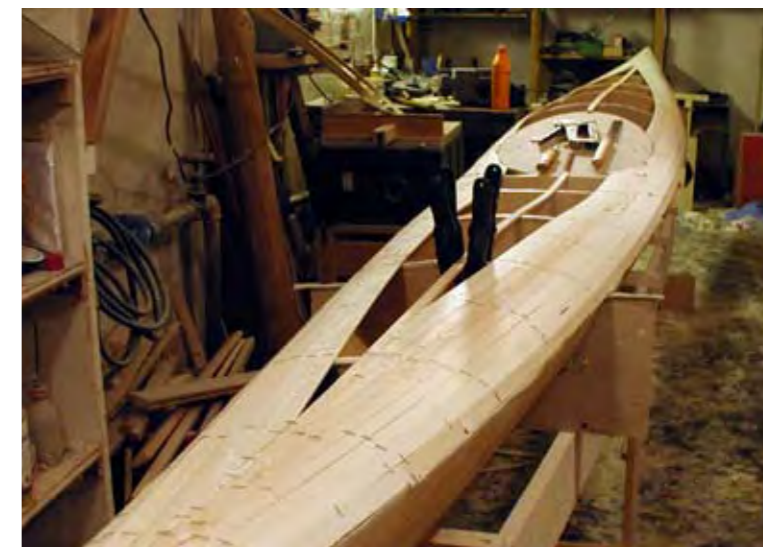
Ovan: Börja med en noga injusterad centerribba. Oftast är det en bra idé att ha en utsågad ”sittbrunn” i spånskiva för att få ribbningen runt sittbrunnen rätt
