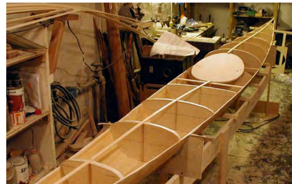
Ovan: Börja med en noga injusterad centerribba. Oftast är det en bra idé att ha en utsågad ”sittbrunn” i spånskiva för att få ribbningen runt sittbrunnen rätt
