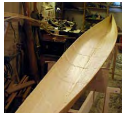
Insidan väntar på samma behandling som utsidan – fast med lite lägre krav på finish
