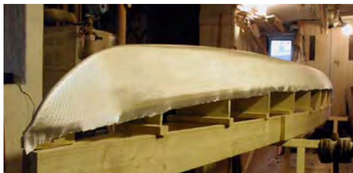
Glasfiberväv nogra utslätad över hela skrovet
